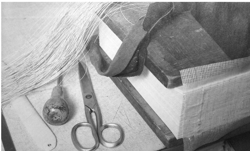
Ein Gazestreifen wird auf den beschwerten und somit fixierten Buchblock aufgeklebt.
